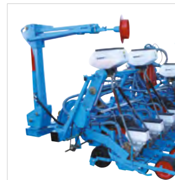
Складаний гідравлічний маркер рядків з диском для складаної рами (доступні різні моделі в залежності від типу рами)
